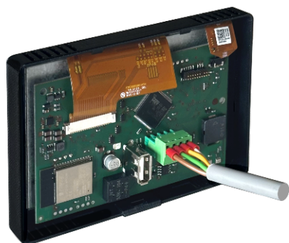
Morsetto con cavo inserito per il collegamento al display
